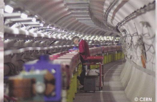
Il fascio di neutrini muonici viene prodotto al CERN utilizzando protoni di alta energia (400 GeV) estratti dall'acceleratore SPS. Circa ogni tre secondi vengono fatti interagire  $2.4 \times 10^{13}$  protoni (24.000 miliardi) con un bersaglio costituito da 13 cilindretti di grafite di pochi millimetri di diametro.
